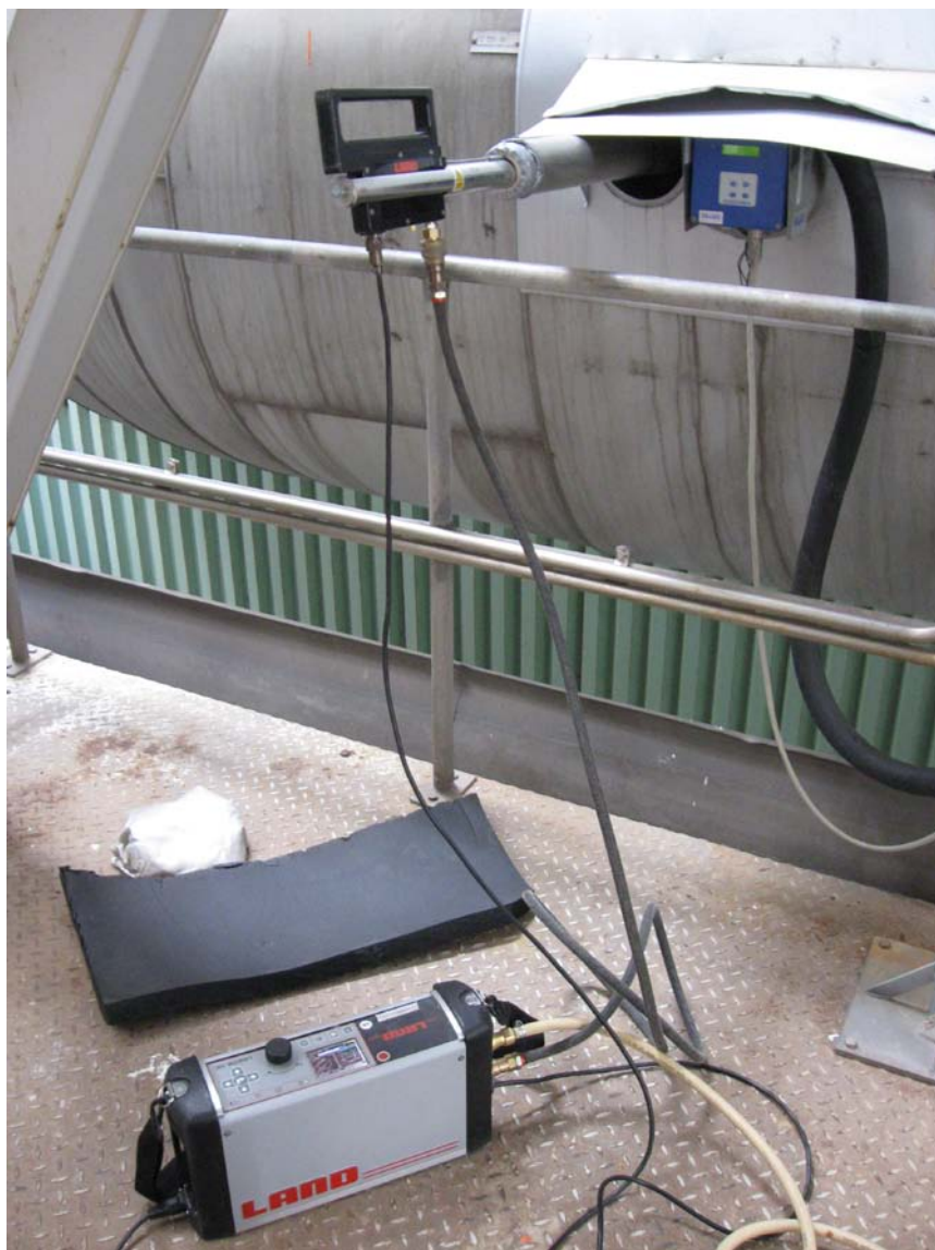
Figur 6. Svavelsyradaggunkten uppmättes mellan elfilter och ekonomiser med en Lancom 200 Acid Dewpoint Monitor.
