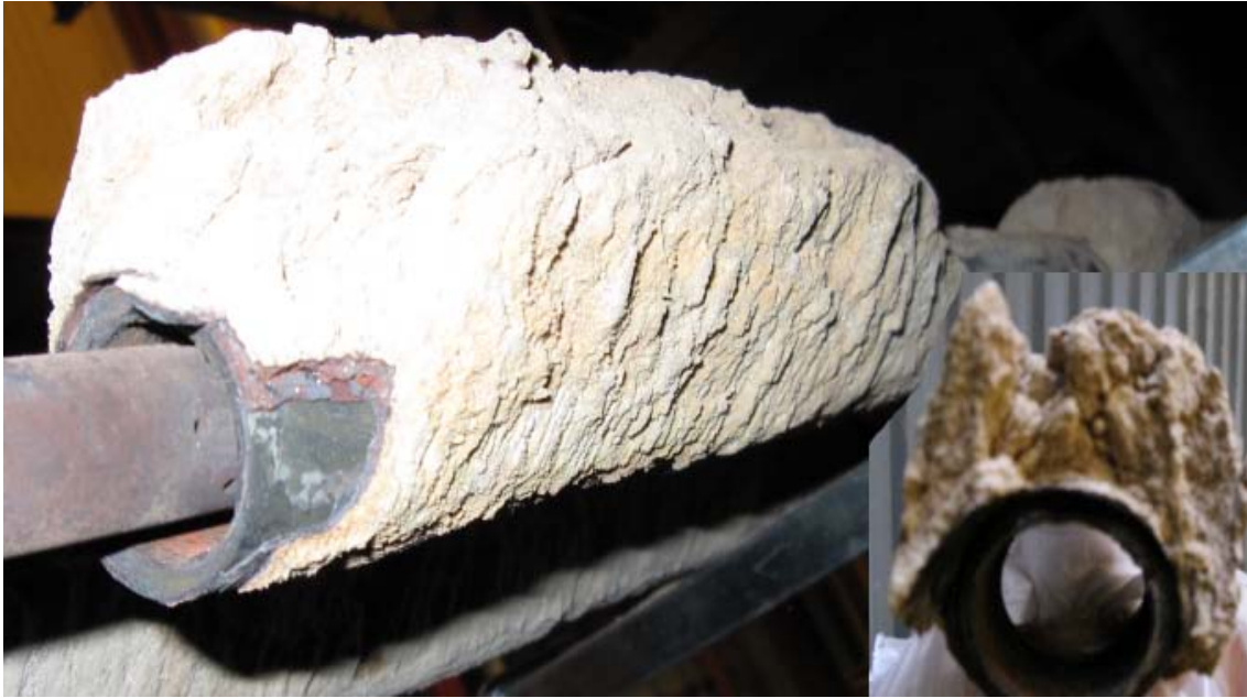
Figur 27. Fotografier på korrosionssonden direkt efter uttag efter 1000 timmar vid 450°C (materialtemperatur) i referensfallet. Den inklippta bilden till höger visar en provring direkt efter att den demonterats från korrosionssonden.
