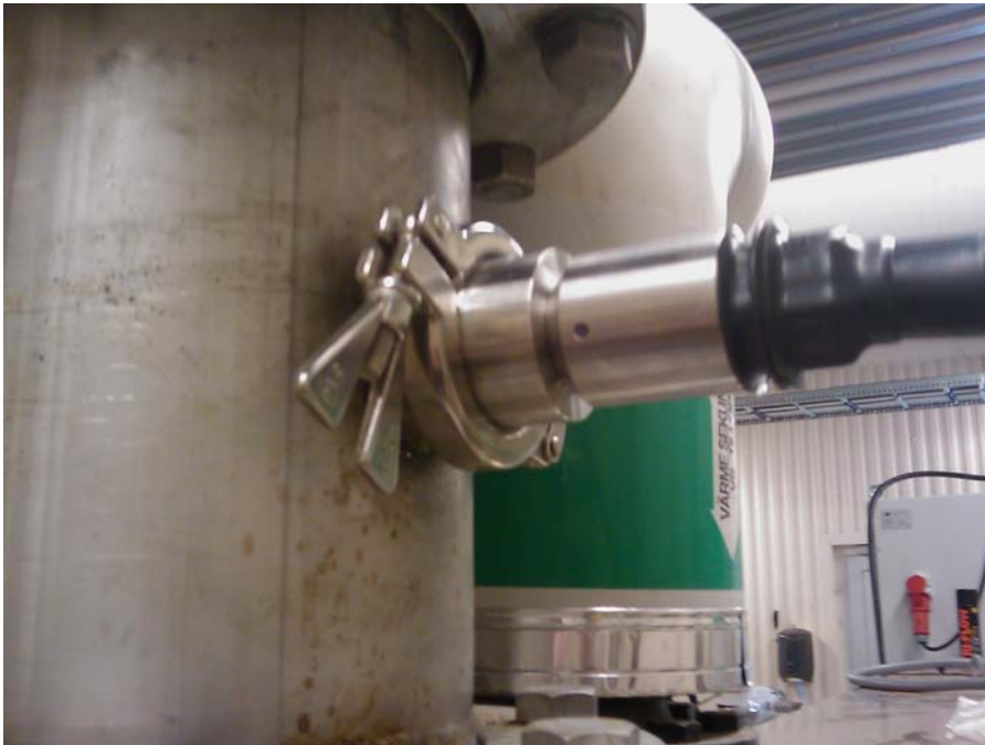
Figur 4. Reflektanssondens placering i det vertikala röret på rötkammarens cirkulationsslinga.
