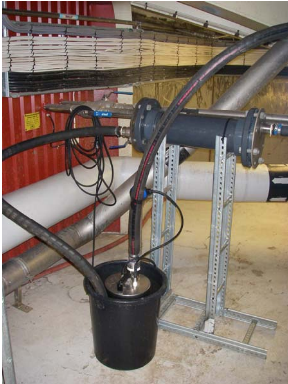
Figur G7. Off-lineslinga för kalibrering av mikrovågsinstrumentet med insamlade prover.
