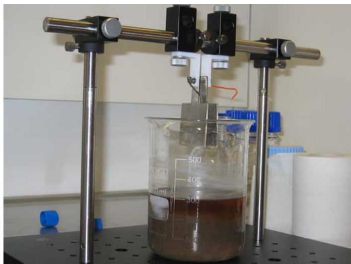
Figur F2. Experimentell uppställning. De rostfria elektroderna fästs i en ram som tillåter att enkelt ändra avståndet mellan elektroderna. Alla försök gjordes på 0,5 L substrat, med eller utan magnetisk omröring. Bilden visar ett sedimentarat substrat (efter 0,5 timme). Vid mätningar sänktes elektroderna ca 5 mm under substratytan.
