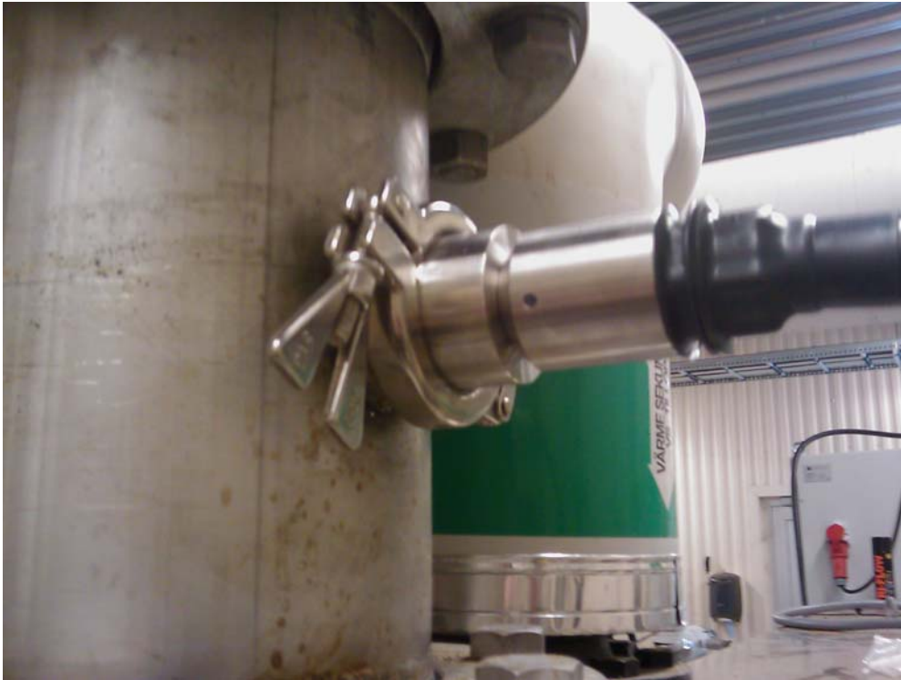
Figur J4. Reflektanssensondens placering i det vertikala röret på rötammarens cirkulationsslinga Figure J4. The reflectance probe placed in the vertical pipe for the circulation of digester content.
