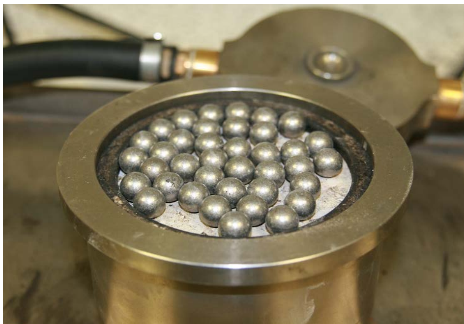
Figur 11. Slitageprovning enligt Prall med stålkulor Figure 11. Abrasion test according to Prall using steel balls
