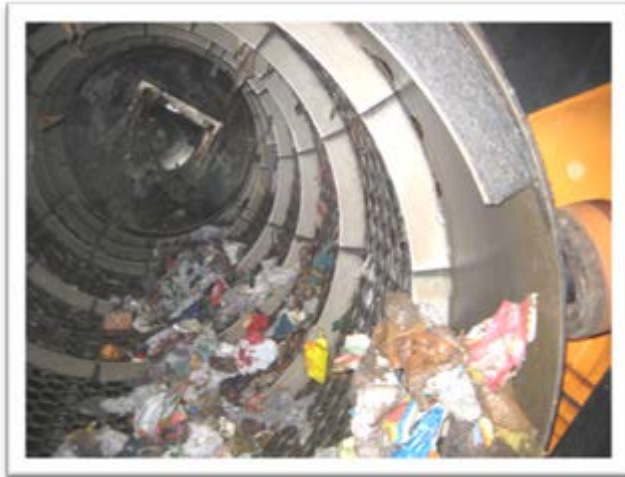
Figur 7. Bild på hur trumsikten avskiljer plast från matavfallet. (Foto: Uppsala Vatten och Avfall)
