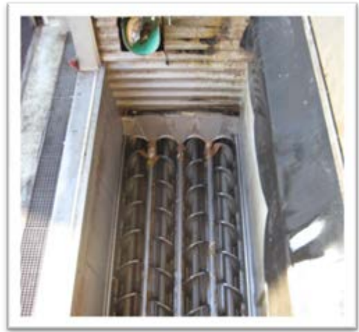
Figur 8. Bufferticka där blandningen av det rena organiska materialet sker. (Foto: Uppsala Vatten och Avfall)
