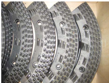
Figur 3. Dispergeringsringar. (Foto: Uppsala Vatten och Avfall)
