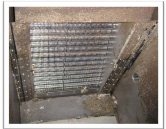
Figur 8. Bufferticka där blandningen av det rena organiska materialet sker. (Foto: Uppsala Vatten och Avfall)
