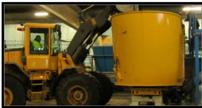
Figur 13. Påsarna lastas i en blandarvagn som är en ombyggd fodervagn med två omrørare. (Foto: Johan Yngvesson)
