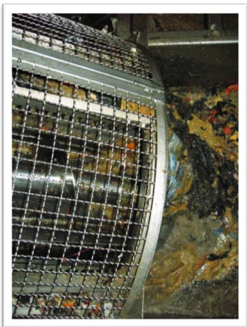
Figur 17. Bioseparatören inleds med ett roterande silgaller som separerar flytande material såsom plast. (Foto: Johan Yngvesson)
