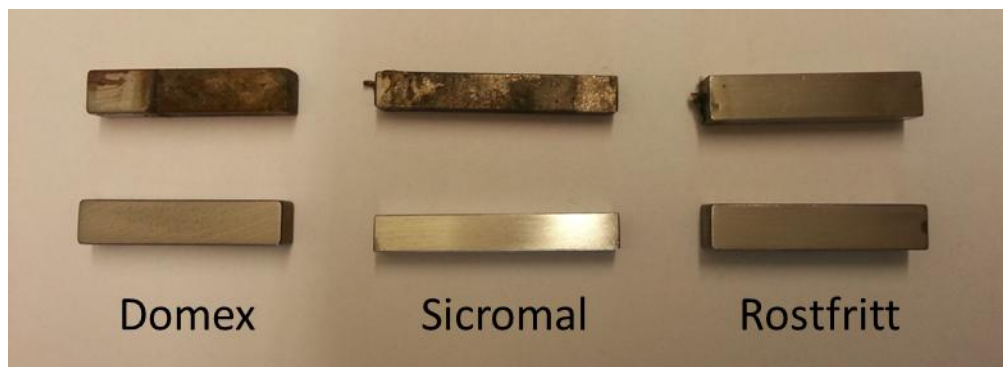
Figur 31. Foto som visar påverkan på stålet med pressvätska från Företag C. Raden ovan visar efter genomförda tester medan den undre raden visar icke exponerat material. (Kamerans blixter ger en reflektion i Sicromalstålet, de råa materialen har dock samma blanka yta).
