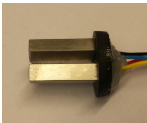
Figur 32. Inconel efter experiment med pressvätska från företag C. Till synes ingen påverkan på materialet alls (ingen rengöring har gjorts efter testet).
