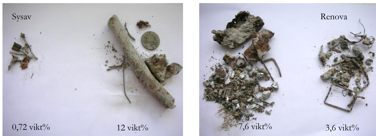
Figur 36. Exempel på bortplockade icke malbara metaller från provet innan kemisk analys. Den vänstra bilden (Sysav) representerar en aska som genomgått metallseparation innan provtagningen medan den högra (Renova) representerar en anläggning som tagit prov innan metallseparation. De två siffrorna i varje bild representerar mängden som är bortplockat från respektive replikat.
