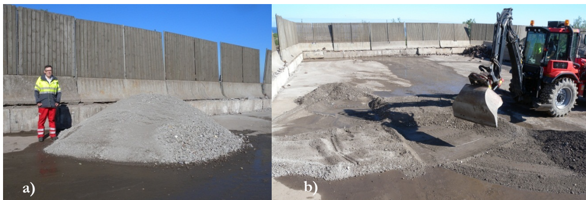
Figur 3. Provtagningsprocedur vid Sysav a) Samlingsprov efter provtagning av den sorterade slaggen. b) Neddelning av slaggruset med kon och kvadreringsmetoden.
