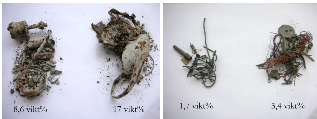
Figur 6. Exempel på bortsorterade icke-malbara fraktioner från två olika bottenaskor (vänster respektive höger bild). Varje bild illustrerar också skillnaden mellan utsorterade mängder i de två replikaten för respektive aska.
