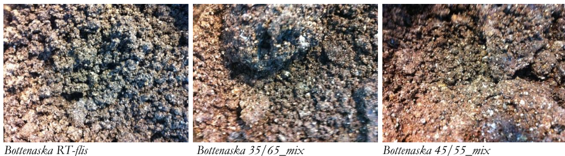
Figur 8. Bottenaskor från de tre proveldningarna. Antalet agglomerat och storleken på dem ökade med en ökad inblandning av slam till RT-flis.
