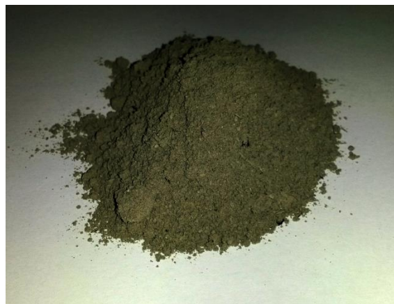
Figur 12. Flygaska från förbränning av slambränsleblandning, prov till utvinning av fosfor.
