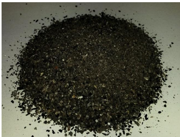
Figur 11. Bottenaska från förbränning av slambränsleblandning, prov till utvinning av fosfor.
