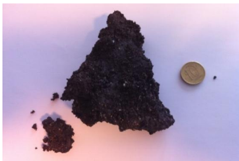
Figur 9. Exempel på en klump av bottenaska från förbränning av 45 % slam och 55 % RT-flis. (Bredvid provet finns en 10-krona.)
