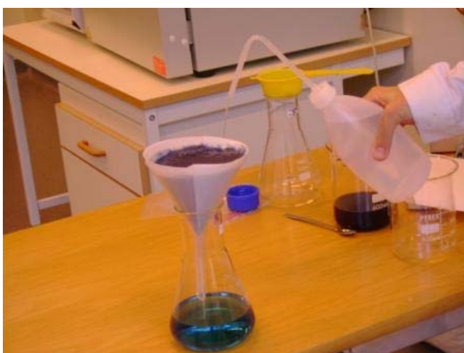
Figure 20. 7. Washing the cellulose. Figur 20. 7. Tvättning av cellulosan.
