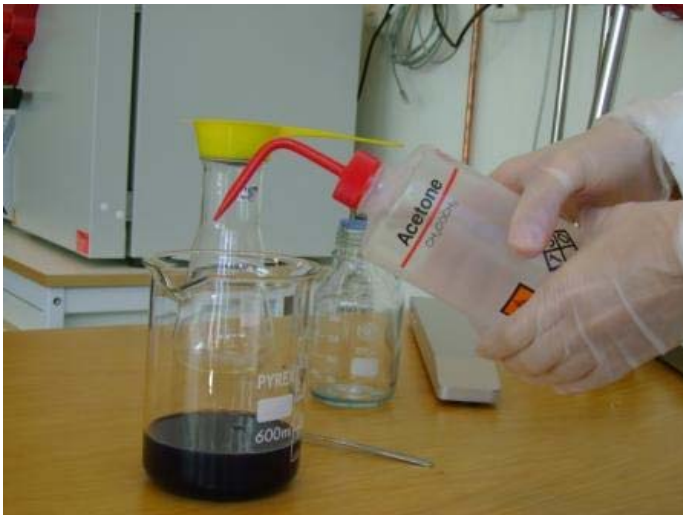
Figure 17. 4. Acetone is added to precipitate the cellulose in the solution. Figur 17. 4. Aceton tillsätts för att fälla ut cellulosan i lösningen.
