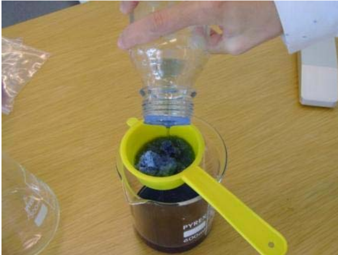
Figure 16. 3. Filtration of the mixture Figur 16. 3. Filtrering av blandningen.
