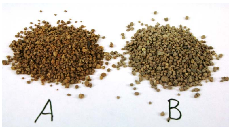
Figur 17. Retursand från PVA1: A) Normal bäddtemperatur 080602, B) Efter 30 h under 750°C, 080618.
