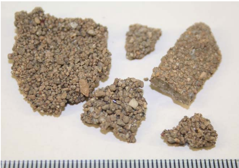
Figur 15. Exempel på agglomerat i bottenaska vid normal bäddtemperatur, 080602. Dessa relativt stora partiklar förefaller bestå av en kärna av glas på vilket det fastnat sand.
