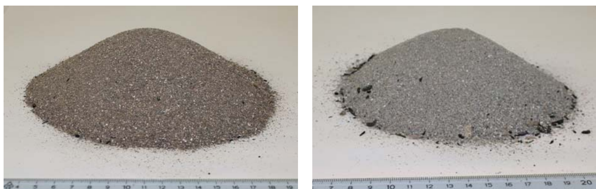
Figur 18. Prover tagna i vändschaktet från PVA1. Vänster) Vid bäddtemperatur runt 870°C, 080602, Höger) Vid bäddtemperatur under 750°C, 080618.
