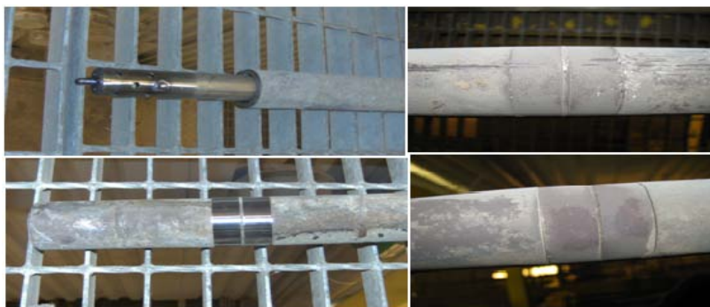
Figur 5. Beläggningssonder som använts vid mätningarna.
