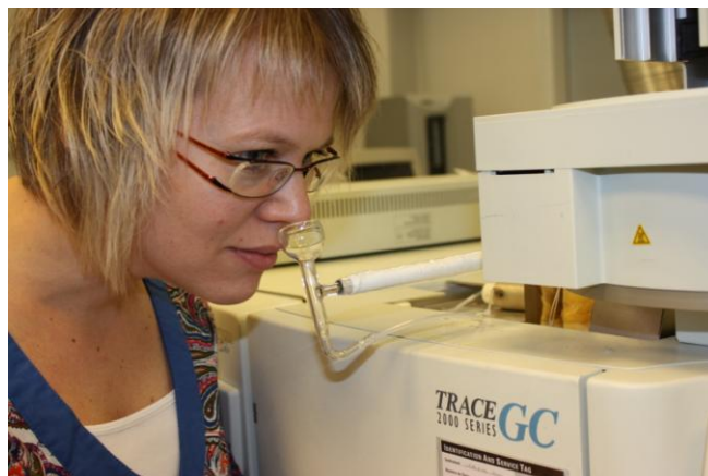
Figur 2: GC-O-analys: En erfaren bedömare luktar på ämnena som kommer från gaskromatografen. Såväl lukternas intensiteter som deras karaktärer bedöms.
