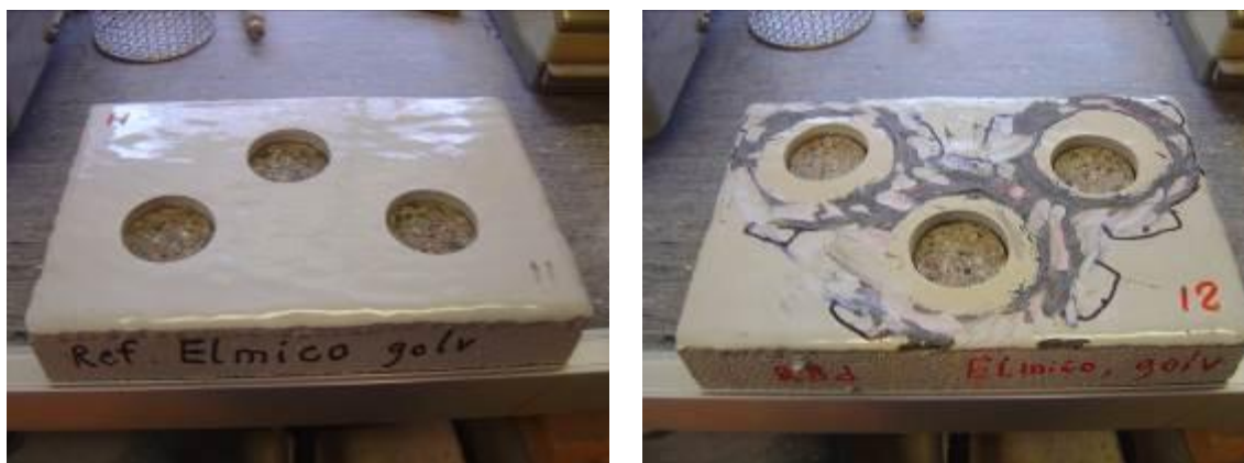
Figur 8. Provplattor med system 3G efter provdragning, utan exponering (vänstra bilden) och efter exponering (högra bilden).
