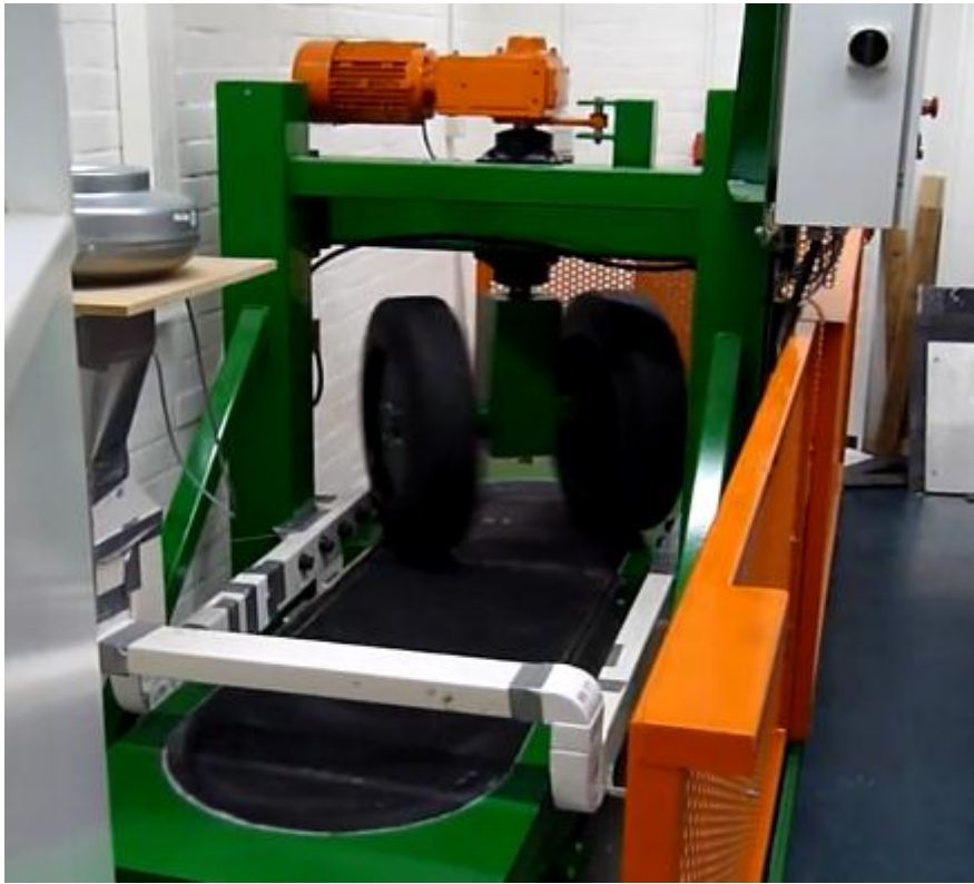
Figur 25. ARTe-utrustning för Scuffing resistance.
