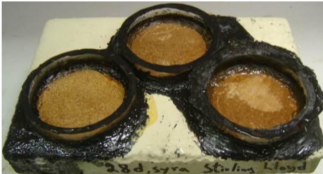
Figur 17. Provplattor med system 13VT efter exponering.
