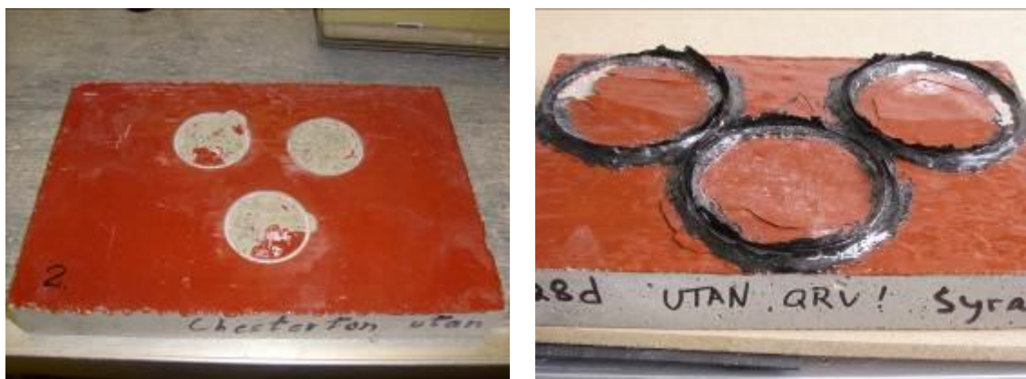
Figur 13. Provpplattor med system 10V, efter provdragning på icke exponerad provplatta (vänstra bilden) och efter exponering då ingen provdragning kunde genomföras (högra bilden).
