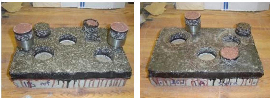
Figur 7. Provplattor med system 1G efter provdragning, utan exponering (vänstra bilden) och efter exponering (högra bilden). MMA primern är rosa till färgen.
