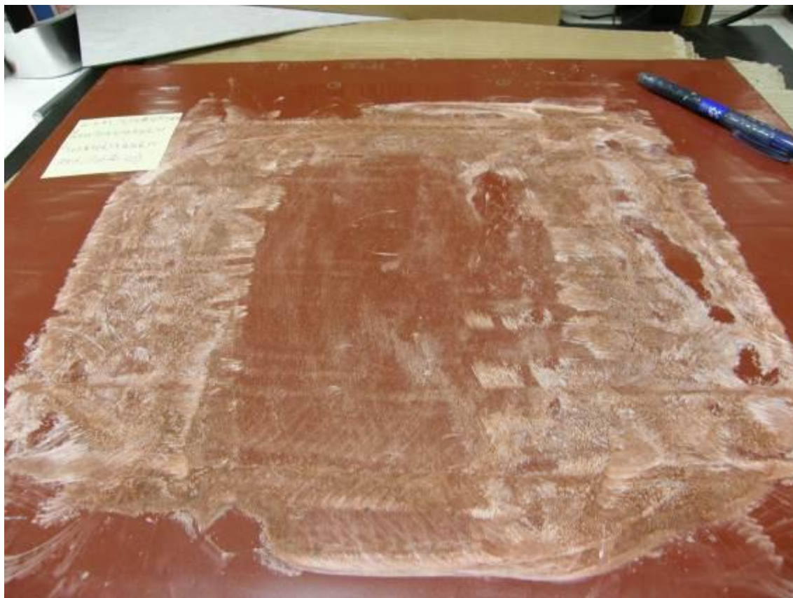
Figur 26. Produkt 4G efter provning enligt SS EN13892-5.
