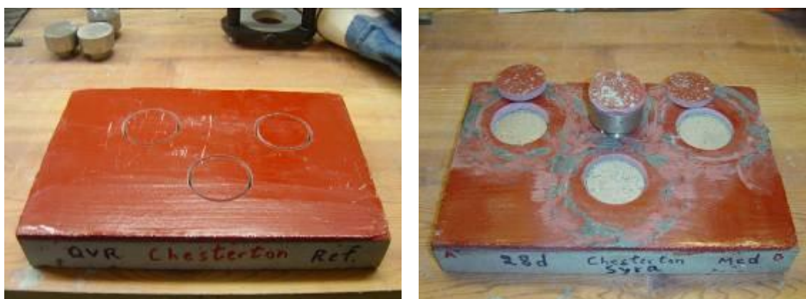
Figur 12. Provplattor med system 4G vid provdragning, utan exponering (vänstra bilden) och efter exponering (högra bilden).
