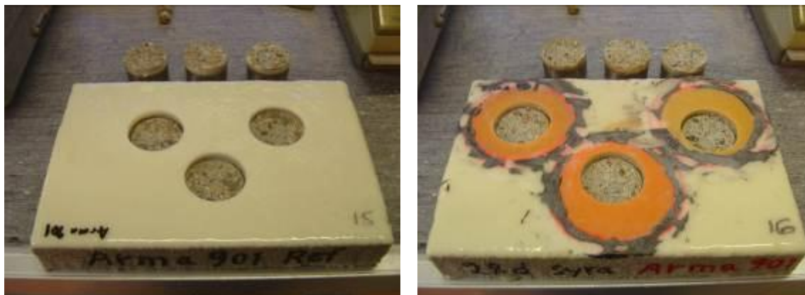
Figur 9. Provplattor med system 8VT efter provdragning, utan exponering (vänstra bilden) och efter exponering (högra bilden).
