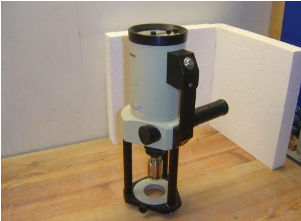
Figur 3. Dragprovningssutrustning vid CBI, Pull-off adhesion tester (10kN)
