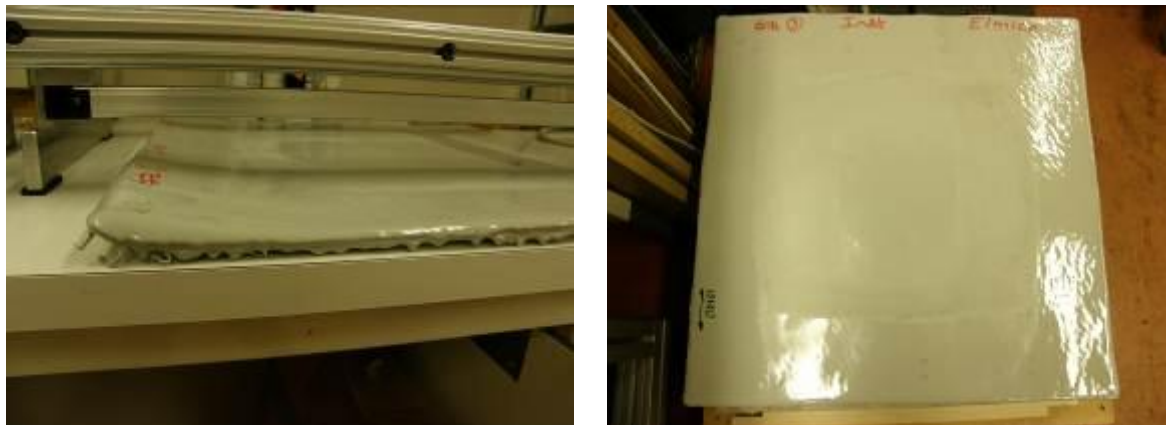
Figur 25. Provplatta av polyurea (3G), ojämna kanter (vänster bild) och efter nötningsprovning (höger bild). Provning enligt SS EN 13892-5.
