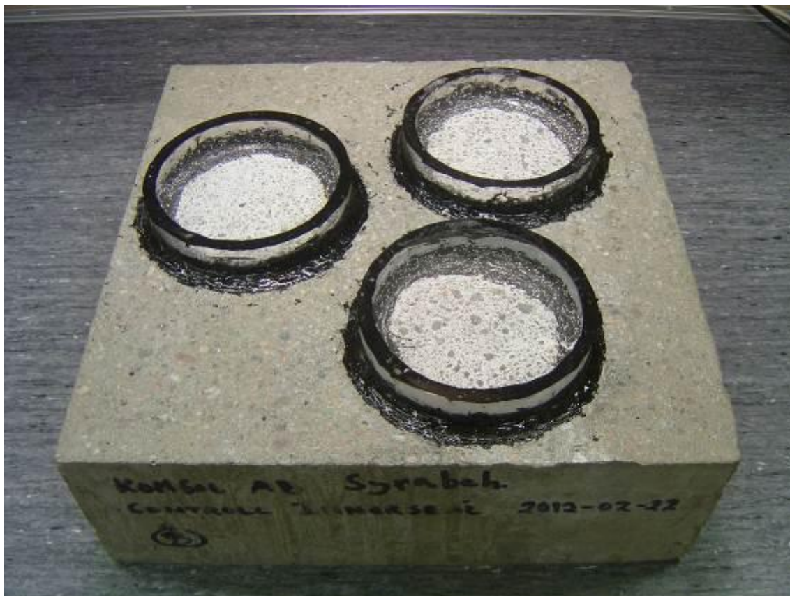
Figur 19. Provplassor som behandlats med silikatprodukt, efter exponering.
