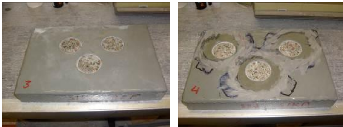
Figur 11. Provplattor med system 11VT efter provdragning, utan exponering (vänstra bilden) och efter exponering (högra bilden).
