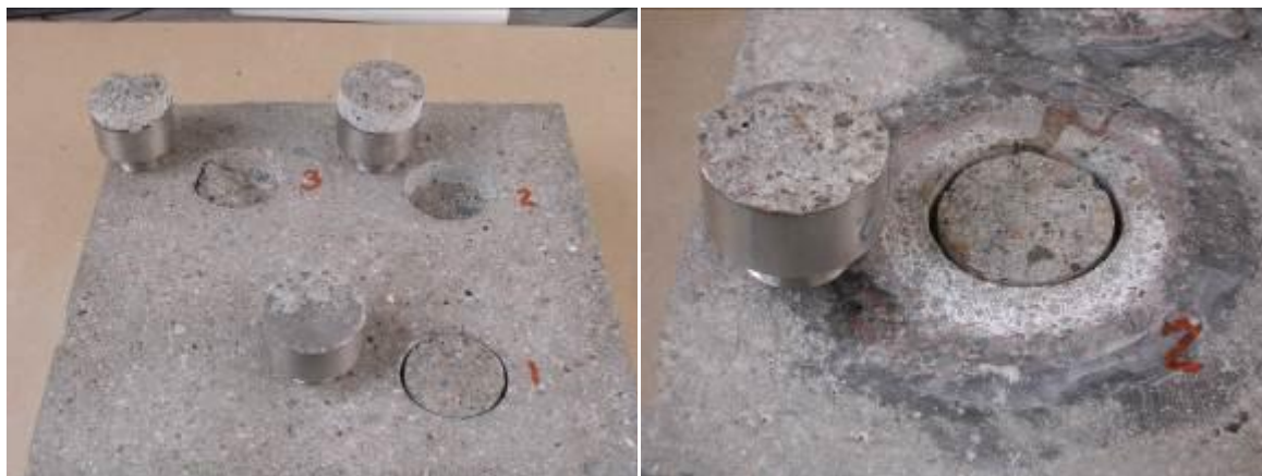
Figur 20. Provplassor som behandlats med silikatprodukt, efter provdragning, utan exponering (vänstra bilden) och efter exponering (högra bilden).
