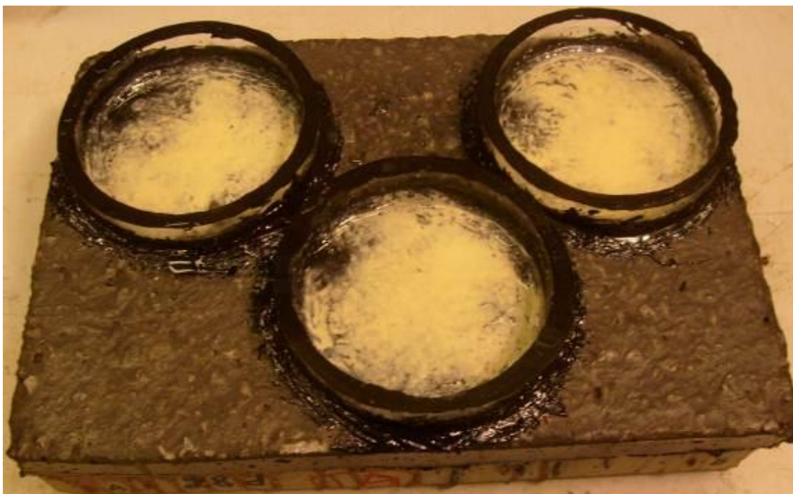
Figur 6. Provplattor med system 1G efter exponering.
