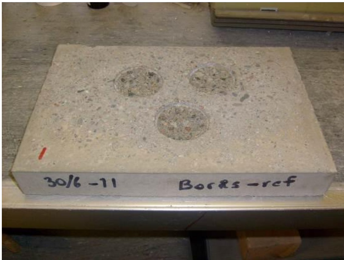
Figur 23. Referensbetong efter provdragning, utan exponering.
