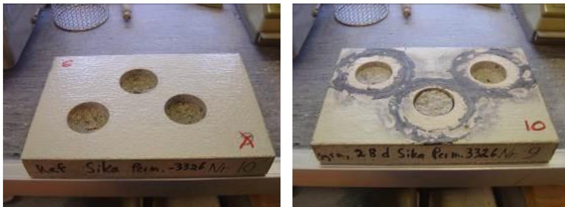
Figur 16. Provplattor med system 12VT efter provdragning, utan exponering (vänstra bilden) och efter exponering (högra bilden).
