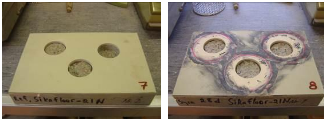
Figur 14. Provplattor med system 5G efter provdragning, utan exponering (vänstra bilden) och efter exponering (högra bilden).
