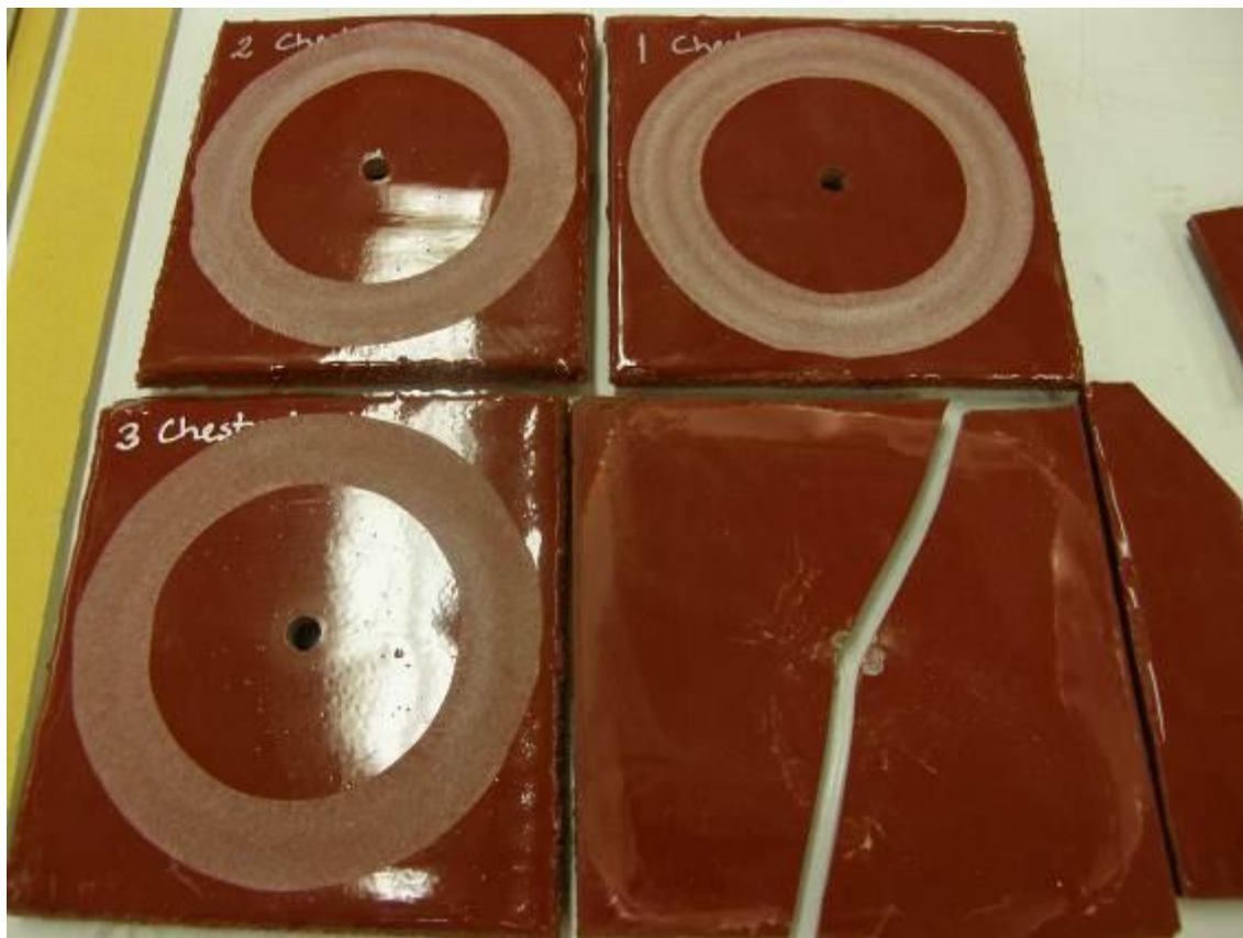
Figur 27. Produkt 10VT efter provning enligt SS EN ISO 5470. Plus sprucket prov.
