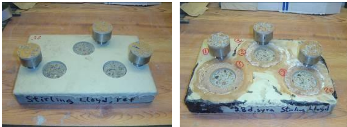
Figur 18. Provplattor med system 13VT efter provdragning, utan exponering (vänstra bilden) och efter exponering (högra bilden).
