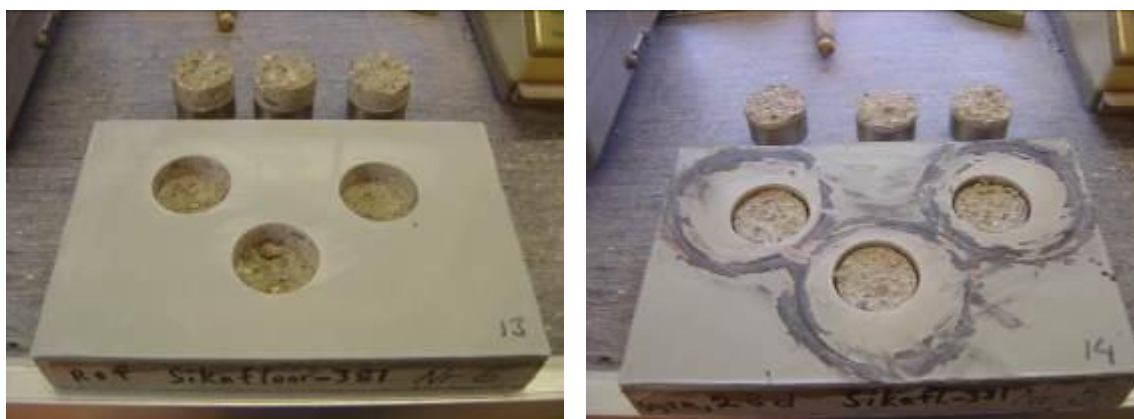
Figur 15. Provplattor med system 6G efter provdragning, utan exponering (vänstra bilden) och efter exponering (högra bilden).
