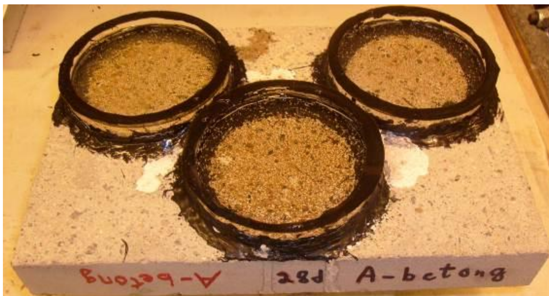
Figur 21. Provplattor av syrafast betong, efter exponering.
