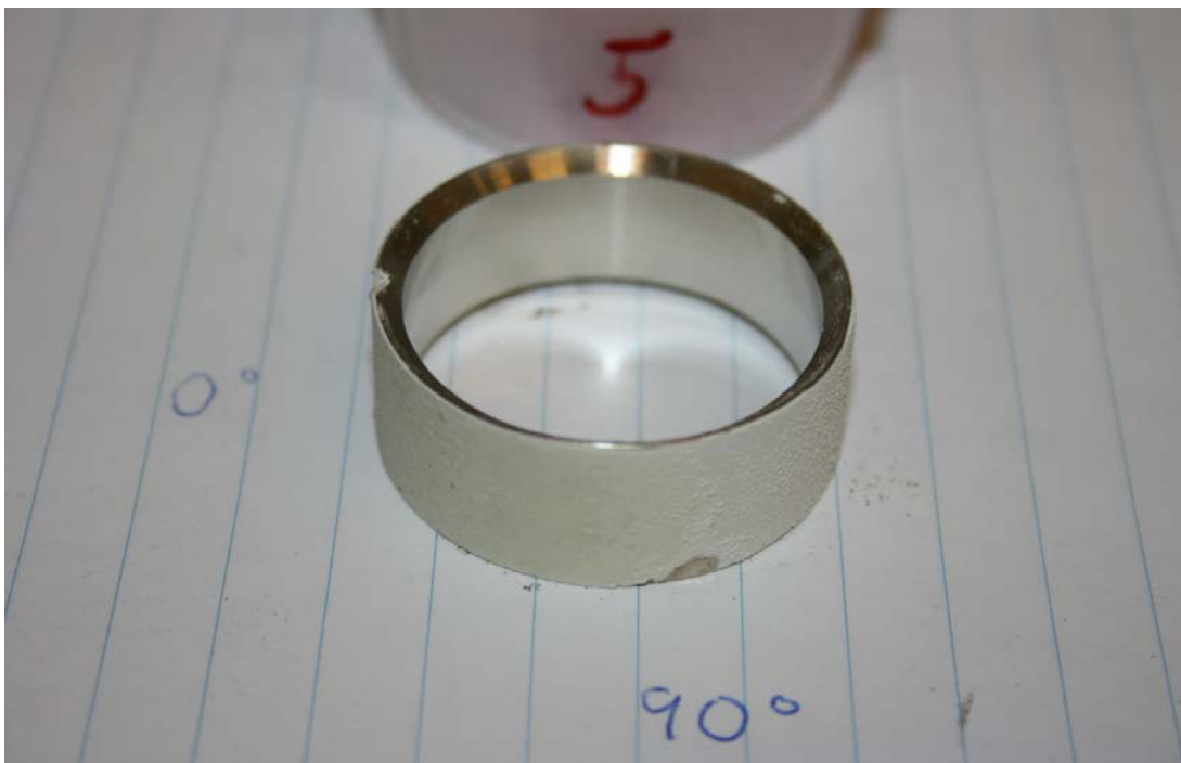
Figur 25. Fotografi av beläggningen från Avfall efter 24 h exponering
