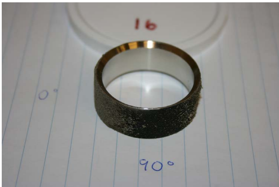
Figur 71. Fotografi av beläggning från Svavel efter 24 h exponering
