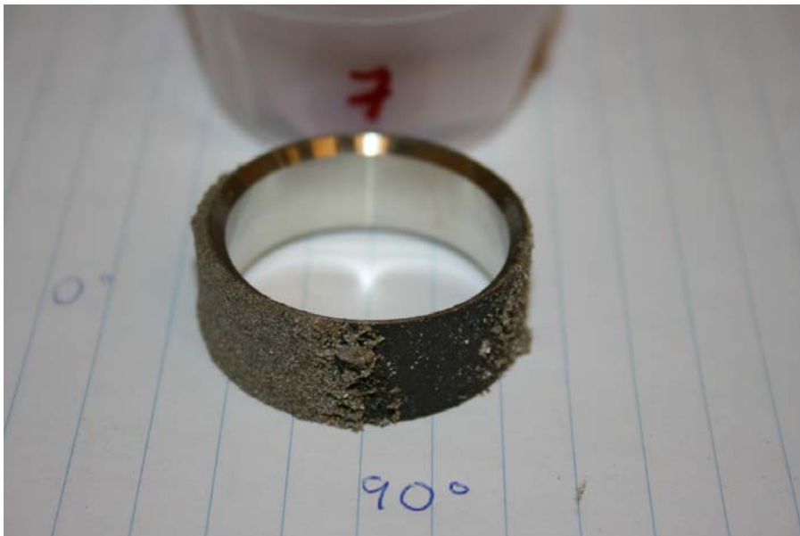
Figur 67. Fotografi av beläggningar från SLF efter 24 h exponering
