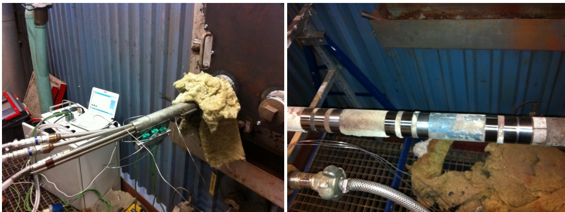
Figur 8. Kyld sond för exponering av provringar vid 630 °C rökgastemperatur Figure 8. Cooled probe for exposure of test rings at 630 °C flue gas temperature
