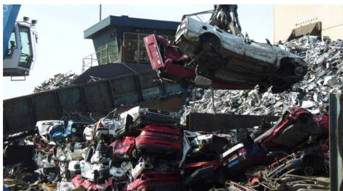
Figur 5. Ingående material till fragmenteringsanläggningen: Bilar, verksamhetsskrot och skrot från kommunens återvinningscentraler
