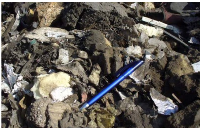
Figur 6. Exempel på SLF (shredder light fraction). Blå penna ditlagd för att se storlek
