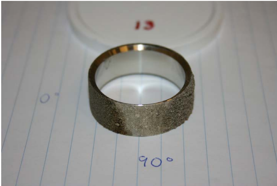
Figur 69. Fotografi av beläggning från SlamM efter 24 h exponering
