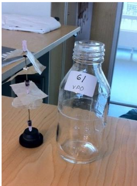
Figur 1 Nålhållare för stöd av provbitar från biopåsar och papperspåse Figure 1 Needle point holder for support of samples from biobags and paperbag
